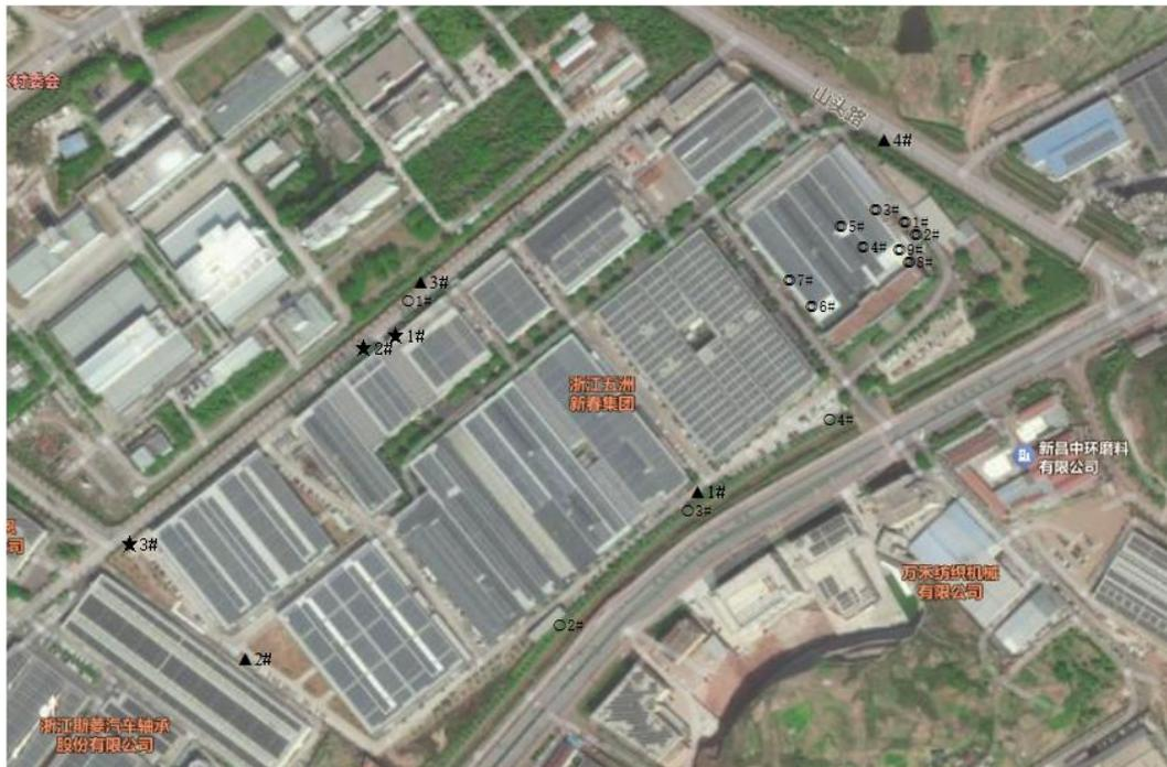
注：★表示废水检测点；○表示无组织废气检测点；◎表示有组织废气检测点；▲表示厂界环境噪声检测点。
